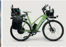
Ardusimple simpleRTK2B und Cohda Wireless Modul => C-ITS-Nachrichten
